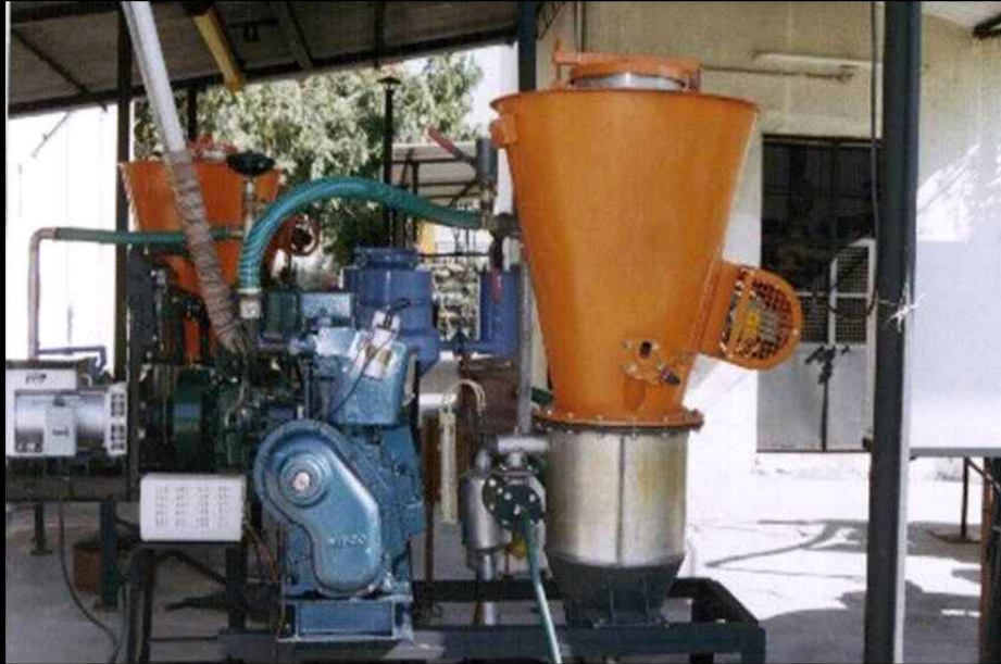
바이오매스를 활용한 콜롬비아의 마을단위 가스화 발전기 4kWe
